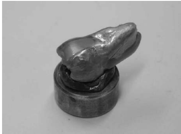
Abbildung 16: Ein für die Randspaltvermessung vorbereitetes Proben-Replika.
