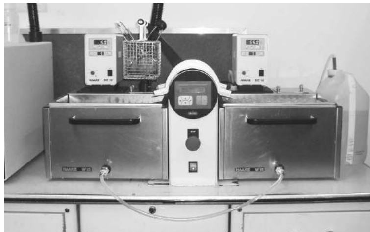
Abbildung 15: Das verwendete Thermocyclinggerät mit zwei Probengruppen.
